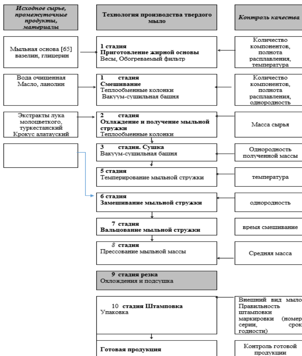
Рисунок 1 - Технологическая схема изготовления антибактериального твердого мыла
